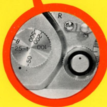
シャッター機構……フォーカル・プレーンシャッターは、ボールベアリングと特許シャッター膜の使用によつて、作動軽快、正確で耐久、耐寒、耐熱性にすぐれております。
