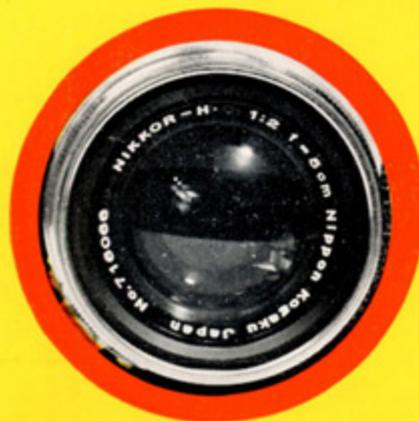
標準レンズ……カラーレンズとして分解能の極めてすぐれているニツコール F2 50mm がつけられております。レンズ構成は6枚で、画角46° 最少絞F16までであり、アタッチメントレンズその他の撮影補助装置を使用しなくとも、距離実測の上で1.5フィートまでの近接撮影が出来ます。
